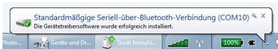
Dem System wird nun ein virtueller COM-Port hinzugefügt. In diesem Fall ist es COM10.
