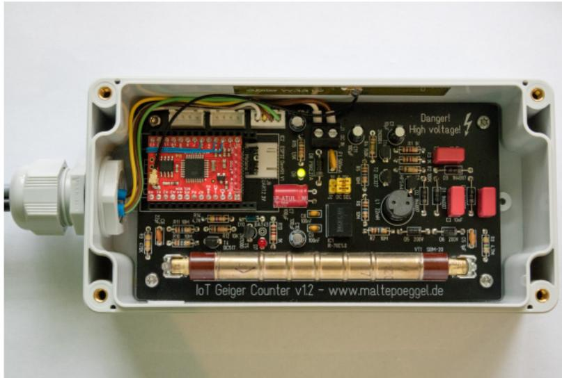
Abbildung: Einbau im IP65 Gehäuse mit Kabelverschraubung, Mehrfachdurchführung und Druckausgleichsmembran
