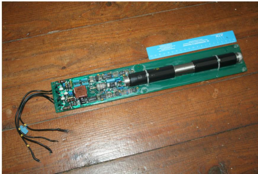
Abbildung: Ausgemusterte Sonde mit zwei Zählrohren
