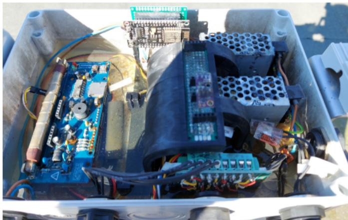
**Abbildung:** Im Außenbereich verhindert ein Druckausgleichselement das Eindringen von Feuchtigkeit (dieses war hier nicht vorhanden)
