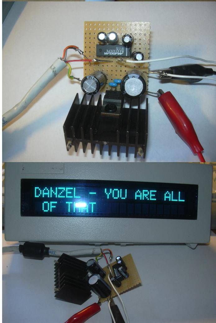
Danach musst du die Displaykabel an die Platine löten. Die Eingangsspannung kann zwischen 9 Volt und 15 Volt betragen. Der Kühlkörper sollte möglichst groß gewählt werden damit der Spannungsstabilisator nicht überhitzt.
